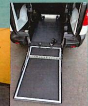
Transport accessible aux personnes en situation de handicap véhicule équipé d'une rampe PMR.
